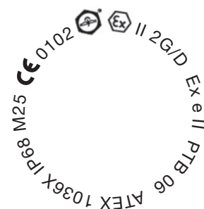
Abb. 2 Beschriftung Druckschraube M25
