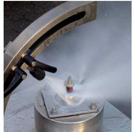
Abb. 6 PFLITSCH Prüflabor: Test IP69K
