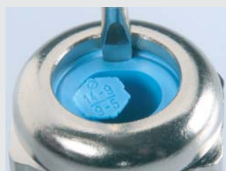
Abb. 3 Bei großem KabelØ – Inlet entfernen: Schraubendreher senkrecht in Trennnaht einstecken
